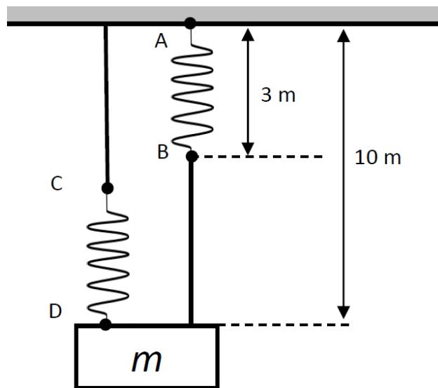
Dvije opruge su sada spojene paralelno na uteg  $m$ , pa je ukupna sila na svaku pojedinu oprugu dvostruko manja nego prije.
