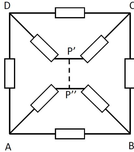
Točke su spojene žicom bez otpora (ekvivalentne su). Napon u obje točke je jednak, pa struja ne teče u žici među njima - što znači da za rješenje našeg problema možemo promatrati kao da ta žica ne postoji. Sada smo pojednostavili krug i možemo ga riješiti konvencionalnim putem. **(5 bodova)**
